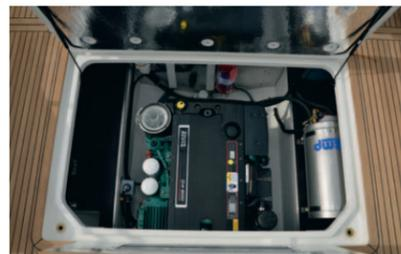
Der im Testboot verbaute Volvo Penta D4-300 ist die stärkste von Paragon für die P25 angebotene Motorisierung. Auch wenn das Boot damit etwas teurer wird – gemessen am Fahrspass ist das sicher die richtige Wahl. Trimmklappen gehören ebenso zur Standardausrüstung wie das Bugstrahlruder, ein Batterieladegerät und der Landanschluss. Bemerkenswert ist die gute Schallisolierung im Innern des Bootes.
